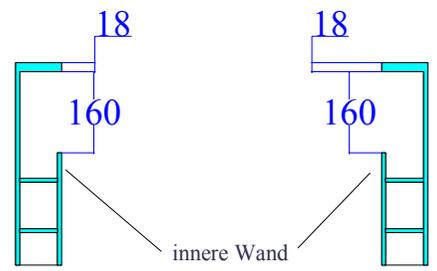
1. In der Mitte von der linken und rechten Platte Ihrer Verbaubox einen Ausschnitt mit den Ø 160 mm anfertigen. Der Ausschnitt darf nur durch die innere Wand gehen. Das Maß von Oberkante Verbaubox beträgt 18mm.
