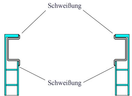
2. Trageblech in den Ausschnitt legen ausmitten und rundum verschweißen. Trageblech und Verbaubox lackieren fertig.
